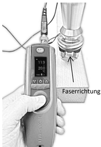
Abbildung: Holzfeuchtemessung – quer zur Faserrichtung
