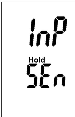
Ist der TF-Stick nicht (korrekt) eingesteckt erscheint bei *langem* (>2 Sekunden) Drücken der Mess-Taste die Anzeige „InP SE“!
