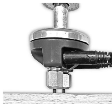
Kuva 9-1: Tefloneristettyjen kärkien käyttö
