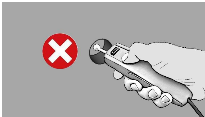
Kuva 9-5: Virheellinen käyttö - mittaus porausreiästä
