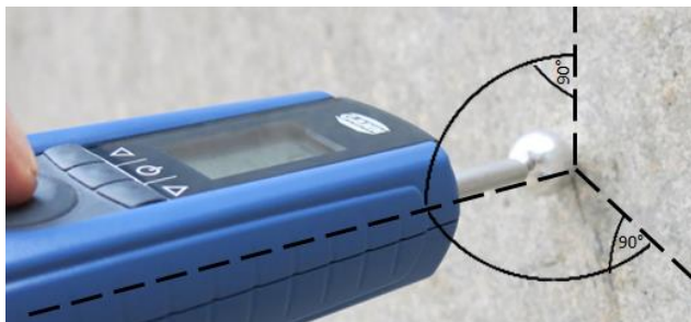
Figura 4-3 Medición en posición horizontal respecto a la superficie de medición
