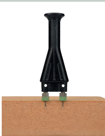
Einschlag-Elektrode M 20 mit speziell isolierten Elektroden-Muttern, die den Einfluss von Oberflächenfeuchte verringern
