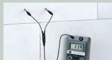
ANWENDUNG Messung mit einem Tiefen-Messelektrodenpaar M 21-250
