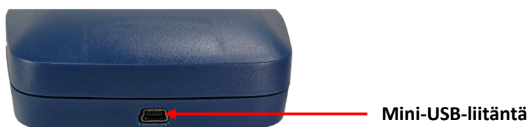
Kuva 2-4: Mini-USB-liitäntä Hydromette CH 17 -laitteen alapäädyssä
