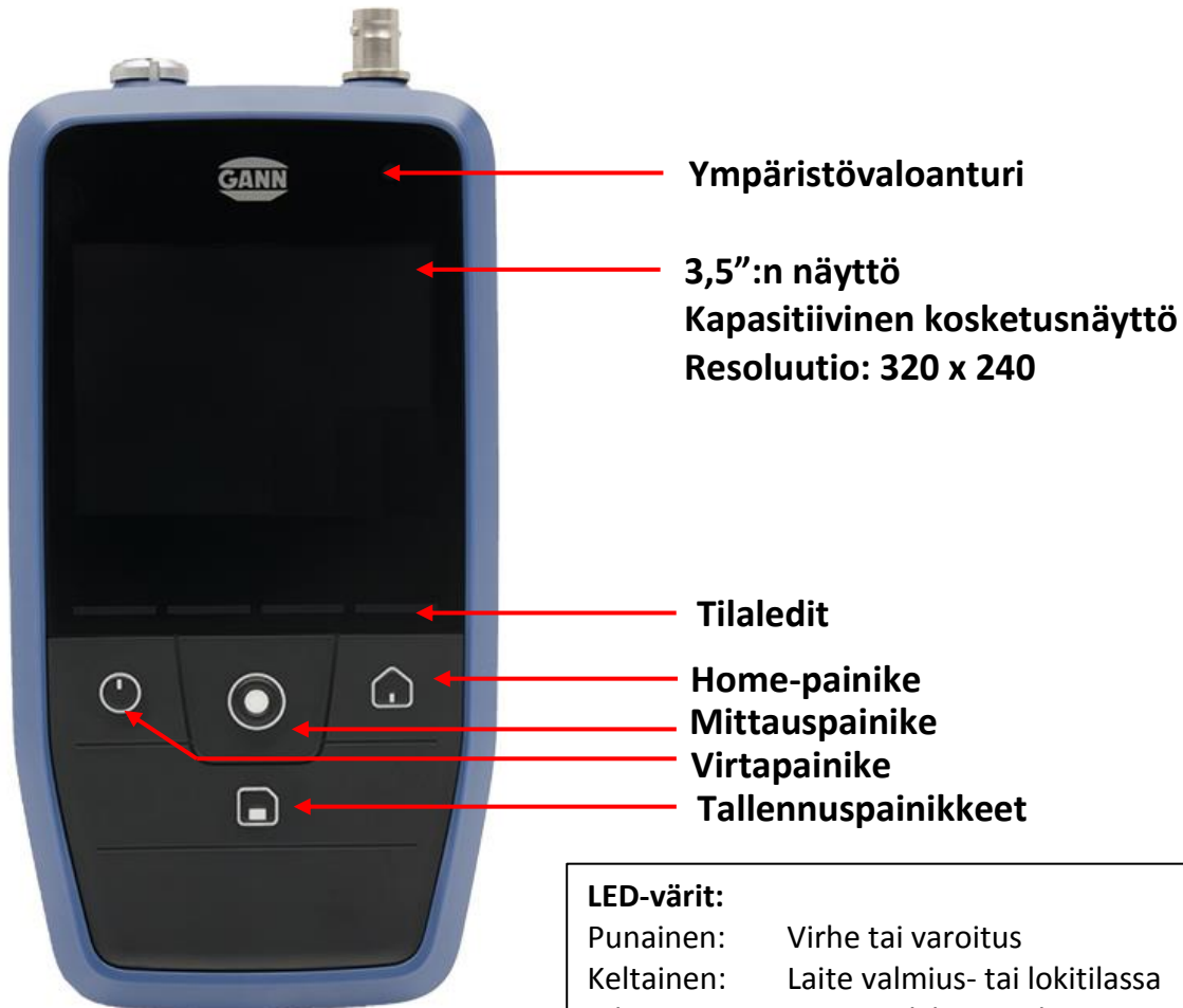
Kuva 2-1: Hydromette CH 17 -laitteen etunäkymä
