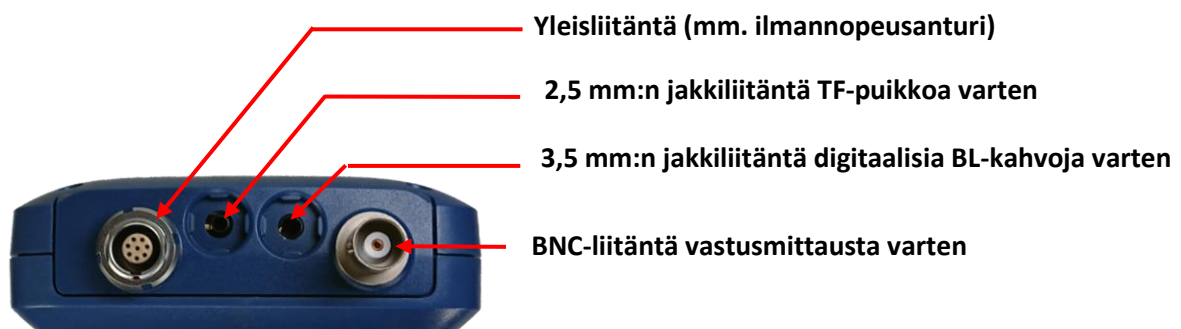
Kuva 2-3: Hydromette CH 17 -laitteen yläpääty, jossa anturiliitännät
