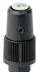
Nach Drücken der Messtaste muss das Gerät  $T_{me\beta} = 0^{\circ}$  mit einer zulässigen Toleranz von **+/- 0,5°** anzeigen.
