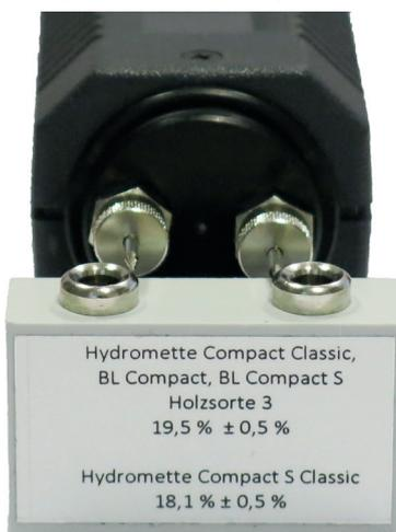
Auch Compact-Geräte können mit dem Prüfadapter geprüft werden. Hierzu werden die Spitzen wie auf den Bildern gezeigt an die Buchsen gehalten. Die Spitzen müssen die Buchsen berühren.
