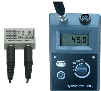
Ist dies nicht der Fall, so empfiehlt es sich, die Kontrolle mittels eines neuen Messkabels MK 8 zu wiederholen, da eine Fehlanzeige in den meisten Fällen durch ein defektes Kabel verursacht wird.
