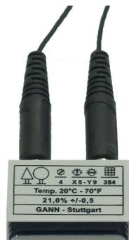
Beispiele für die Prüfung der Hydrometten CH 17 und BL H 40 mit dem Holzfeuchteprüfadapter (verbunden durch das Messkabel MK 8, Art.-Nr. 31006210)
