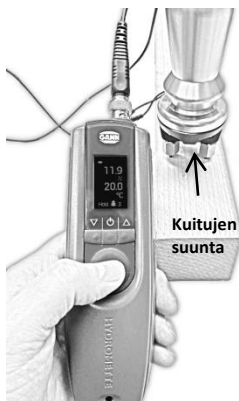
Kuva 3-1: Puun kosteuden mittaaminen – suorassa kulmassa syiden suuntaan nähden
