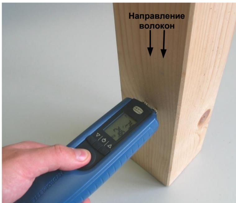
Рисунок 4-1: Измерение против направления волокон
