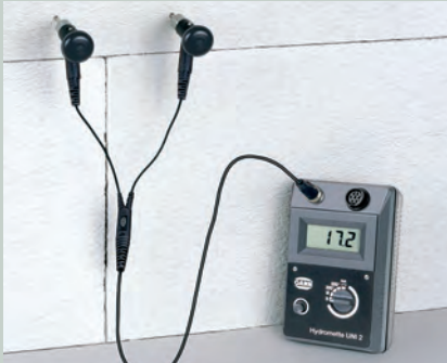
PRAXIS-TIPP Idealer Abstand der Elektroden: 10 cm
