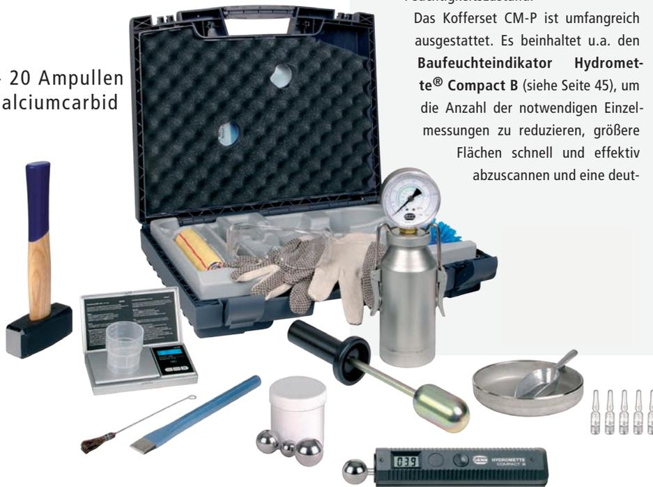
Der HYDROMAT CM-P ist ein Messgerät zur Bestimmung der **Feuchtigkeit in abgebundenen Baustoffen** und diversen anderen Materialien nach der **Calcium-Carbid-Methode**. Alle Messungen können direkt am Objekt mit den im Bereitschaftskoffer enthaltenen Werkzeugen vorgenommen werden und ermöglichen eine schnelle Information über den jeweiligen Feuchtigkeitszustand.
