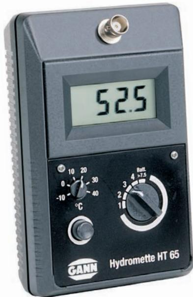
Die HT 65 ist ein elektronischer **Holzfeuchtemesser** nach dem Widerstands-Messprinzip für Präzisionsmessungen von **Schnittholz** (bis 180 mm Stärke), **Spanplatten**, **Furnieren** sowie **Hackschnitzeln** und ähnlichen Schüttgütern.
