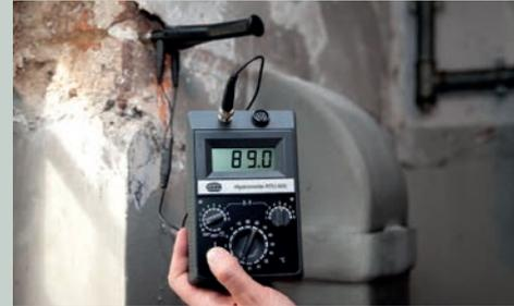
**ANWENDUNG** Die **Einschlag-Elektrode M 20** kann mit Hilfe eines Hammers eingeschlagen werden
