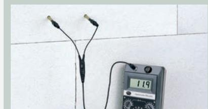
**ANWENDUNG** Messung mit einem Tiefen-Messelektrodenpaar M 21-250
