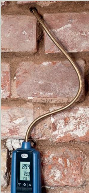
**ANWENDUNG** Mit dem flexiblen Fühlerrohr sind Messungen an schwer zugänglichen Stellen einfach und bequem durchzuführen.
