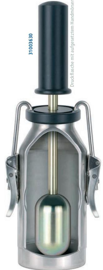
Druckflasche mit aufgesetztem Handmörser
