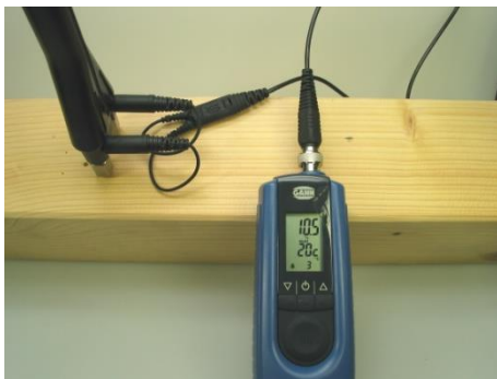
Kuva 4-1 Mittaus poikkisyyden suuntaan M 20:llä
