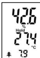
Режим измерения „UGL“ (равновесная влажность древесины):
