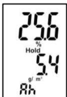
Режим измерения „Ah“ (абсолютная влажность):
