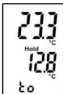
Режим измерения „to“ (смоченный шаровой термометр):
