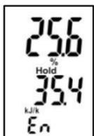
Режим измерения „En“ (теплосодержание):
