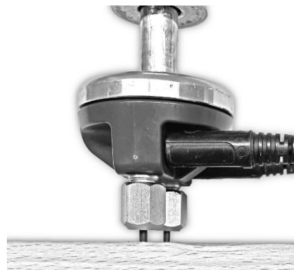
Illustration 9-2 : Utilisation des pointes isolées au téflon
