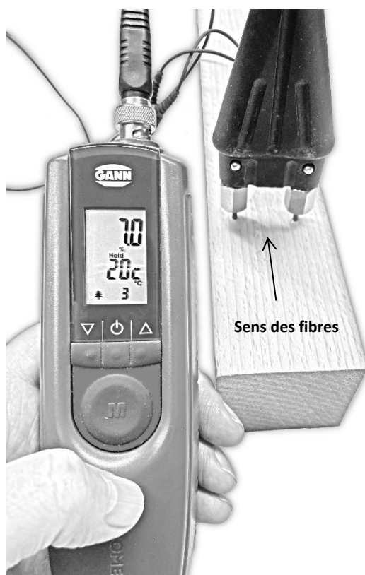
Illustration 9-1 : Mesure de l'humidité du bois – perpendiculairement au fil du bois
