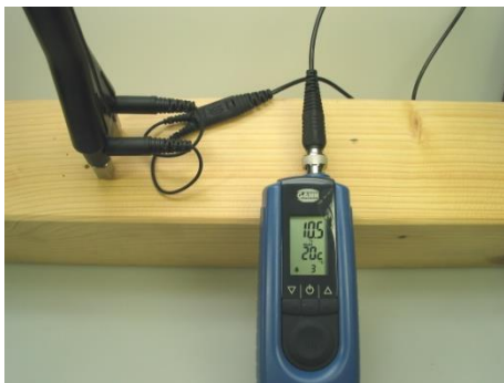
Imagine 4-1 Măsurare perpendiculară pe direcția fibrelor cu M 20
