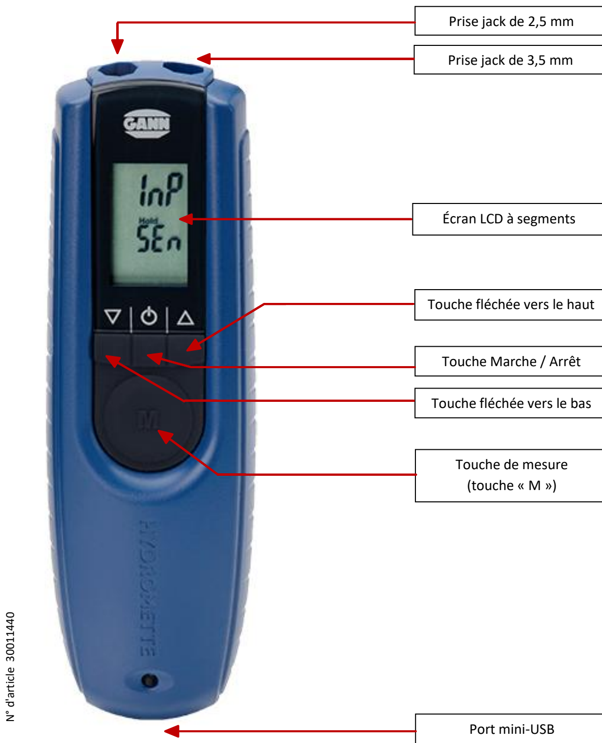
Illustration 5-1 : Vue avant de l'Hydromette BL UNI 11
