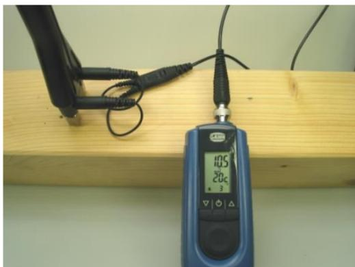
**Abbildung 4-1 Messung quer zur Faserrichtung mit M 20**
