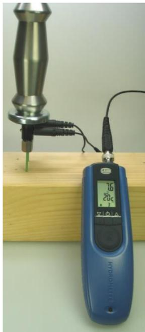
Das Herausziehen der Nadeln erfolgt ebenfalls durch den Gleithammer, mit Schlagrichtung nach oben. Die Sechskant-Muttern sollten möglichst vor Beginn einer Messreihe mit einem Schlüssel oder einer Zange angezogen werden. Lockere Elektrodenspitzen brechen leicht.
