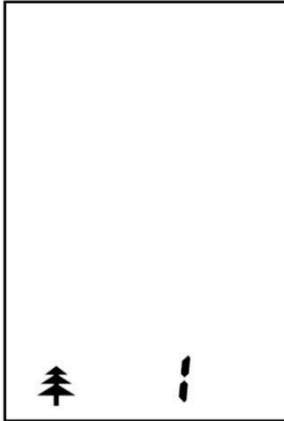
Angezeigt wird die eingestellte Kennzahl mit dem Symbol für die Holzfeuchte.
