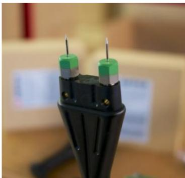
Die Mess-Elektroden werden mittels der Elektroden-Muttern auf der M 20 Elektrode befestigt. (siehe Bild).
