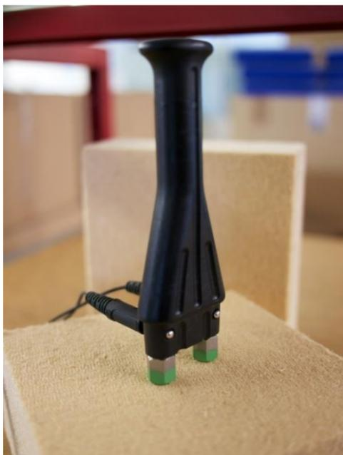
**Abbildung 4-4 Holzfaserdämmstoff Elektrode M20**
