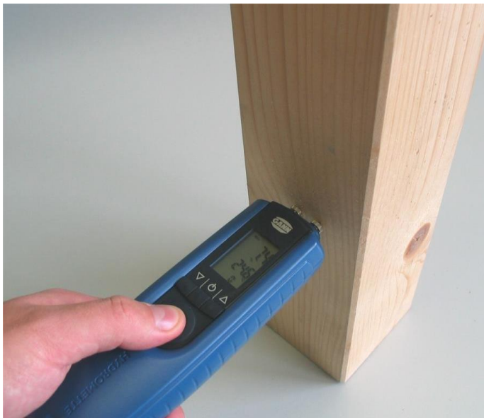
Slika 4-1 okomito mjerenje poprečnog presjeka
