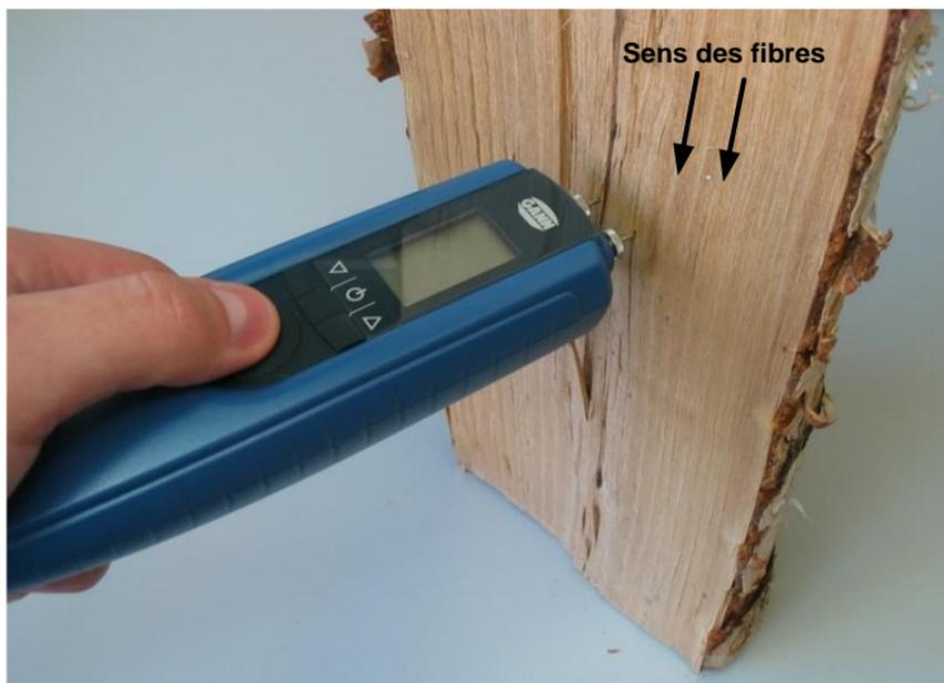
**Figure 4-1 Mesure transversale par rapport au sens des fibres**
