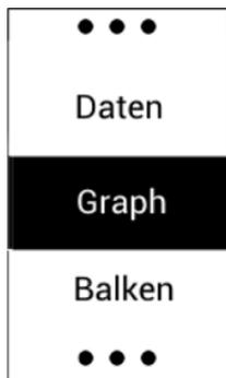
Die Luftgeschwindigkeit wird entweder als Graphen oder als Balken angezeigt. Somit kann die Messgröße schneller erkannt werden.
