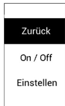
Im Menü „Kompensationsdruck“ kann unter dem Punkt „Einstellen“ manuell ein bestimmter Druck eingegeben werden. Im Messmodus wird die Druckeinstellung rechts oben angezeigt.
