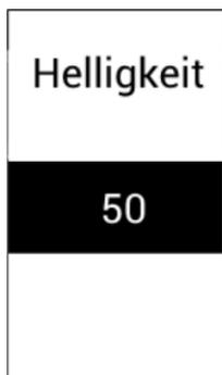
Die Helligkeit der Displayanzeige kann Stufenweise eingestellt werden. Es ist zu beachten, dass mit höherer Helligkeit der Stromverbrauch steigt und somit die Betriebszeit sinkt.
