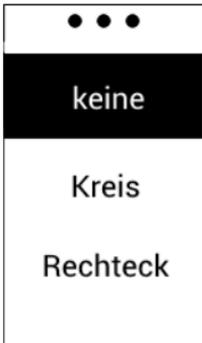
Für die **Berechnung des Volumenstroms** kann man einen Durchmesser bzw. zwei Kantenlängen eines Luftkanals eingeben. Deaktiviert man in diesem Menü die Volumenstrommessung (Auswahlpunkt „keine“), so wird wieder die Luftgeschwindigkeit angezeigt.
