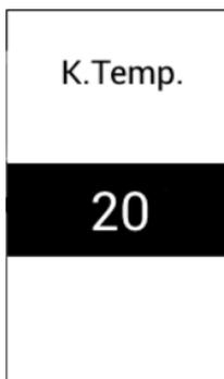
Die werksseitige Einstellung der Kompensationstemperatur für den Luftgeschwindigkeitswert beträgt 20 °C.
