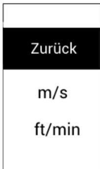
In diesem Menü lässt sich das Einheiten-System vom Metrischen („m/s“) in das Imperiale („ft/min“) umstellen.
