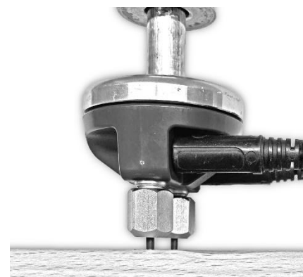
Illustration 9-2 : Utilisation des pointes isolées au téflon
