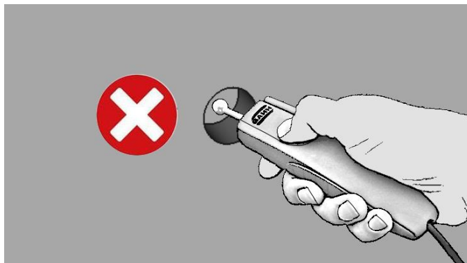
Kuva 13-4: Virheellinen käyttö - mittaus porausreiästä
