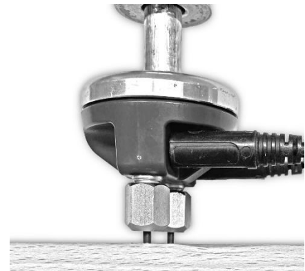
Illustration 13-2 : Utilisation des pointes isolées au téflon
