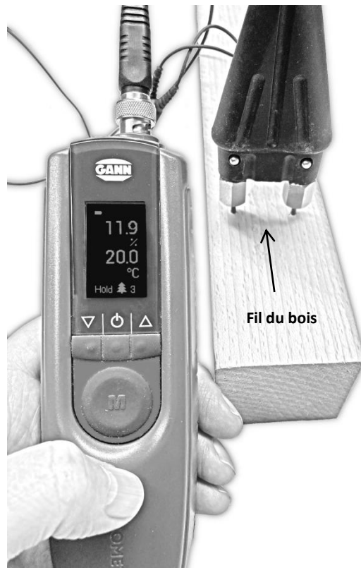
Illustration 13-1 : Mesure de l'humidité du bois – perpendiculairement au fil du bois
