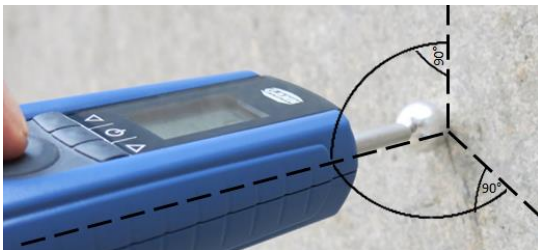
Afbeelding 4-3 Meting zo verticaal mogelijk t.o.v. het meetoppervlak
