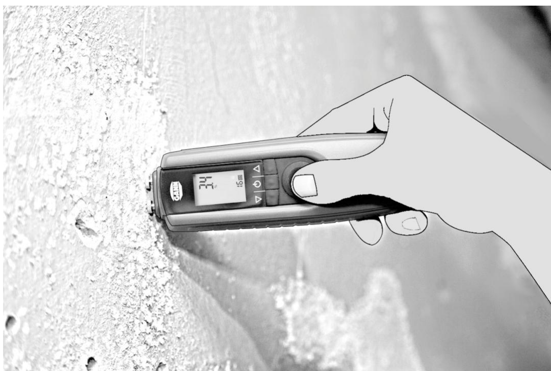
Kuva 7.2: Rakennuskosteuden mittaus – rappauksen mittaus
