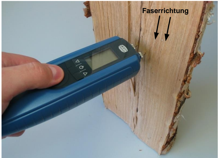
Abbildung 4-1 Messung quer zur Faserrichtung
