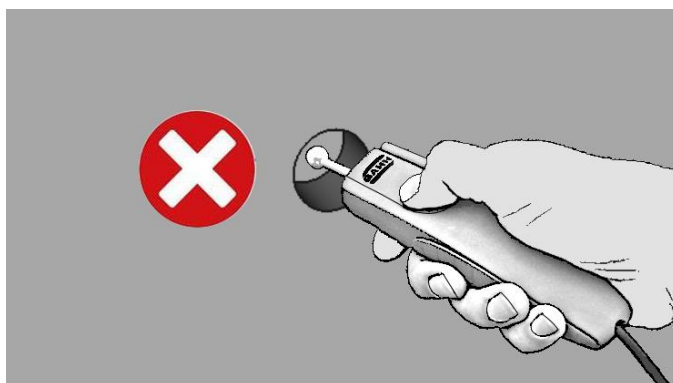
Abbildung 13-5: Falsche Anwendung - Messung im Bohrloch
