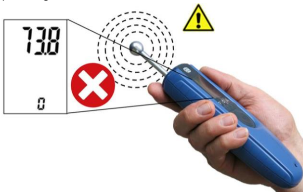
Fig. 4-2 Modo sbagliato d'impugnare l'apparecchio
