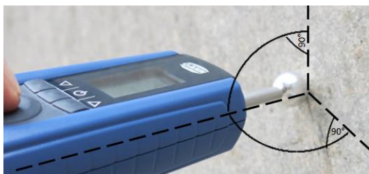
Fig. 4-3 Tenere l'apparecchio possibilmente verticale rispetto alla superficie dove si esegue la misura
