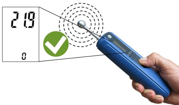
Fig. 4-1 Giusto modo d'impugnare l'apparecchio
