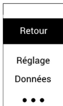
Si les touches « Haut » ou « Bas » sont actionnées en mode veille, le menu principal s'affiche. Utilisez les boutons « Haut » et « Bas » pour naviguer dans le menu. La sélection d'un point de menu s'effectue en appuyant sur la touche de mesure. Les trois points en haut ou en bas de l'écran indiquent qu'il y a des points de sélection supplémentaires qui apparaissent lors du défilement.
