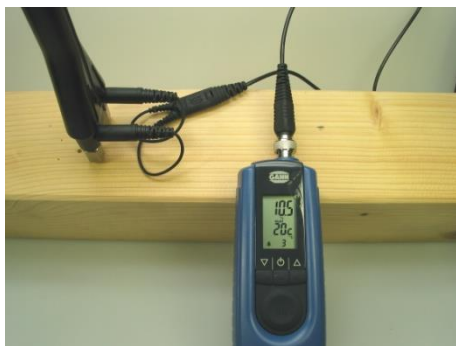
Illustration 4-1 Mesure réalisée à travers les fibres, avec M 20
