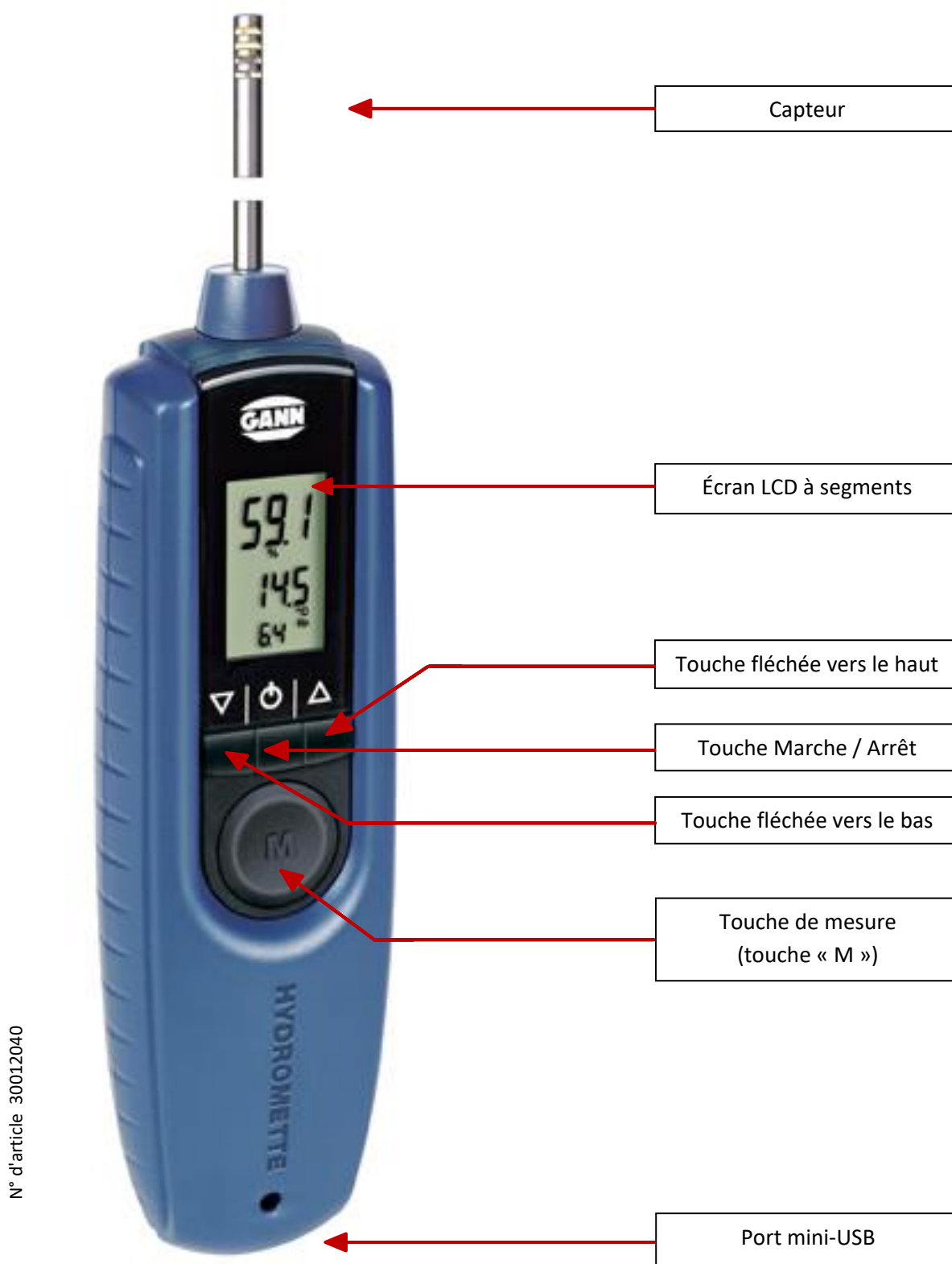
Illustration 5-1 : Vue de l'Hydromette BL Compact RH-T
