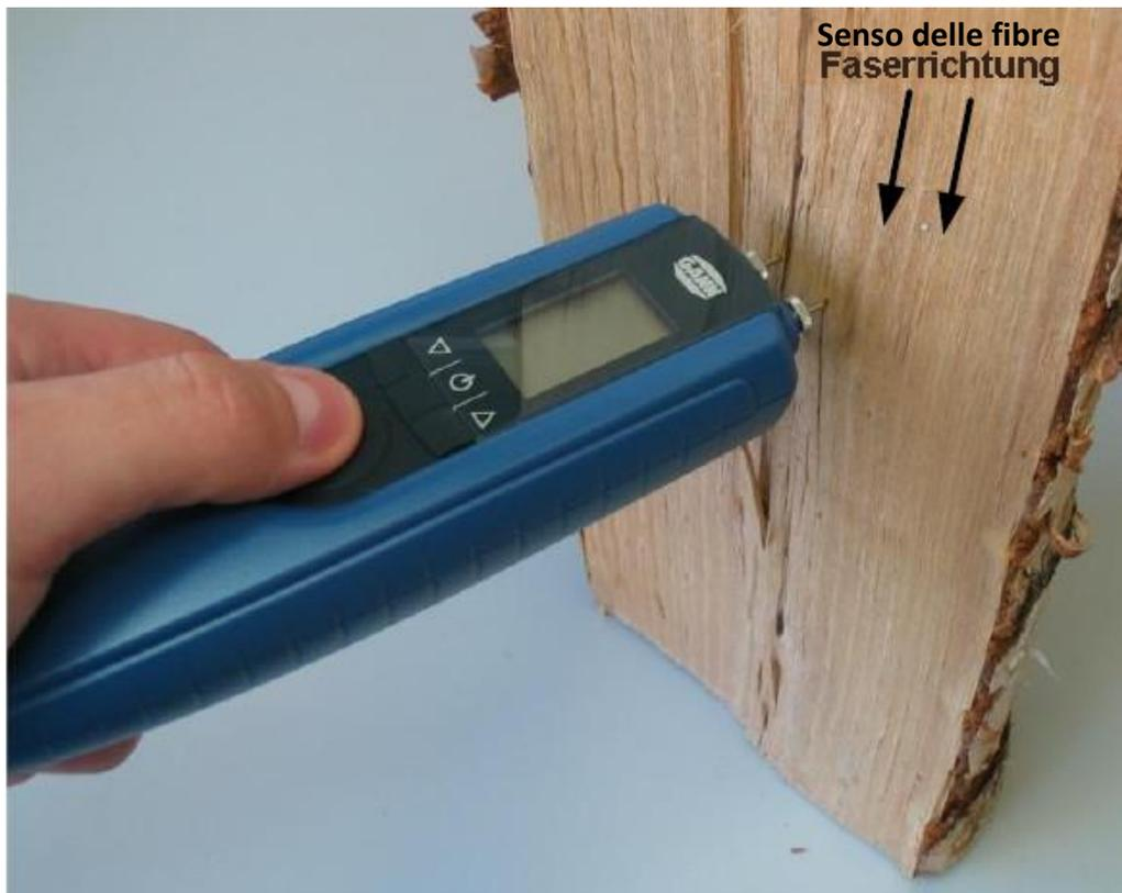
Fig. 4-1 Misura trasversale alle fibre del legno
