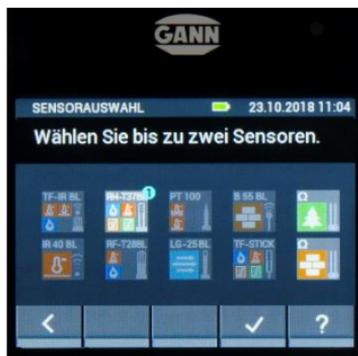
Zur Aktivierung des RHT-Mess-Modus muss nun das Symbol „RH-T 37 BL flex“ ausgewählt werden. Durch Drücken des „Bestätigen“-Buttons wird die Auswahl bestätigt.
