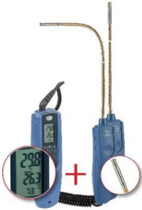
Die Hydromette BL UNI 11 und die Aktiv-Elektrode RH-T 37 BL flex sind über die 3,5mm-Klinkenbuchse miteinander zu verbinden. Auf einen korrekten Sitz des Achtkant-Steckers ist zu achten.
