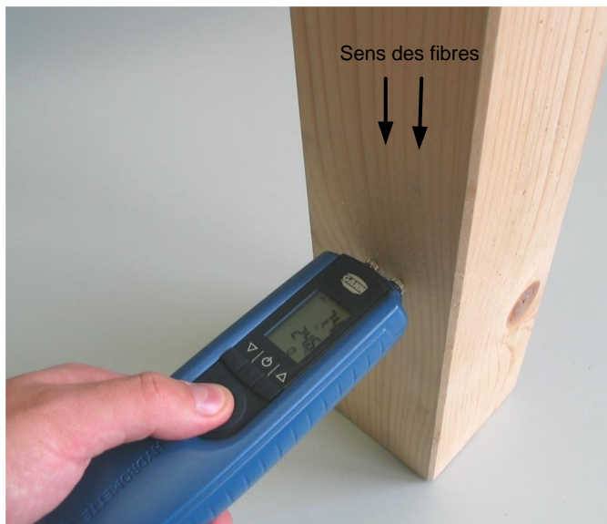
Figure 4-1 Mesure transversale par rapport au sens des fibres
