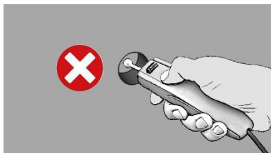
Kuva 5-3 Virheellinen käyttö - mittaus porausreiästä
