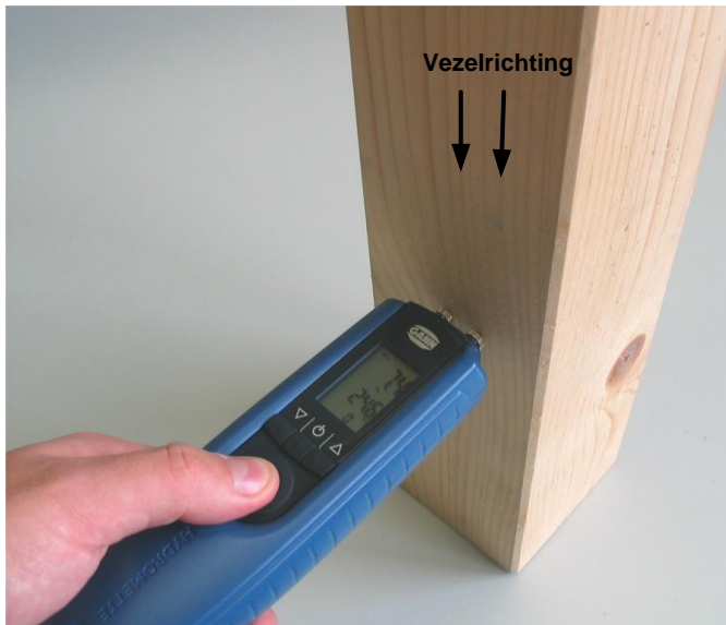
Afbeelding 4-1 Meting dwars ten opzichte van de vezelrichting
