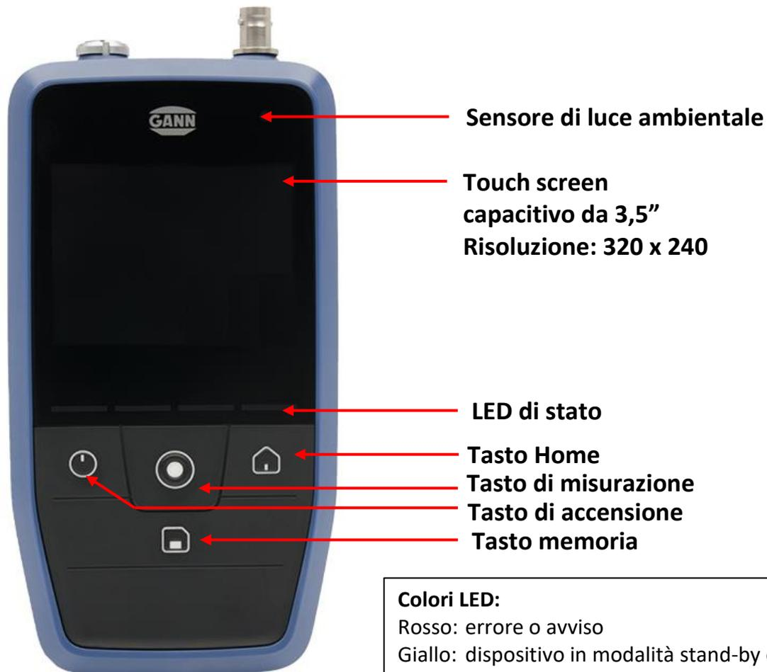
Figura 2-1: Vista anteriore di Hydromette CH 17
