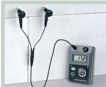
PRAXIS-TIPP Idealer Abstand der Elektroden: 10 cm
