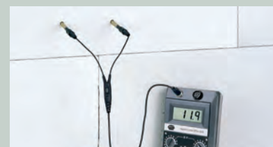
ANWENDUNG Messung mit einem Tiefen-Messelektrodenpaar M 21-250
