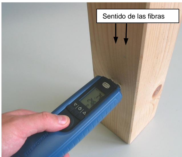
Figura 4-1 Medición en sentido transversal respecto al sentido de las fibras
