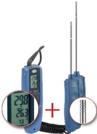
Die Hydromette BL UNI 11 und die Aktiv-Elektrode RH-T 37 BL sind über die 3,5mm-Klinkenbuchse miteinander zu verbinden. Auf einen korrekten Sitz des Achtkant-Steckers ist zu achten.
