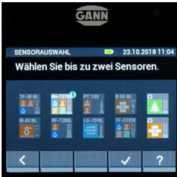
Zur Aktivierung des RHT-Messmodus muss nun das Symbol „RH-T 37 BL“ ausgewählt werden. Durch Drücken des „Bestätigen“-Buttons wird die Auswahl bestätigt.
