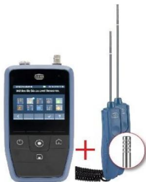
Die Aktiv-Elektrode RH-T 37 BL ist über die 3,5mm-Klinkenbuchse mit dem Messgerät zu verbinden. Dabei ist auf einen festen Sitz des Achtkant-Steckers zu achten. Das Messgerät erkennt nun automatisch das angeschlossene Zubehör.
