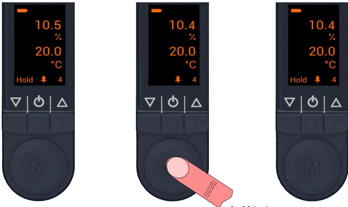
Abbildung 8-2: Messvorgang der Basismessung
