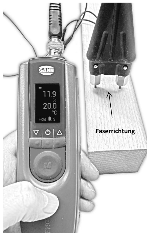
Abbildung 13-1: Holzfeuchtemessung – quer zur Faserrichtung
