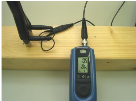
Kuva 4-3 Mittaus poikkisyyden suuntaan M 20:llä
