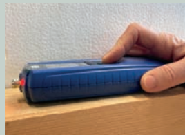
Zerstörungsfreie Messung mittels punktueller Auflage [LED-Signal bei Grenzwertüberschreitung]
