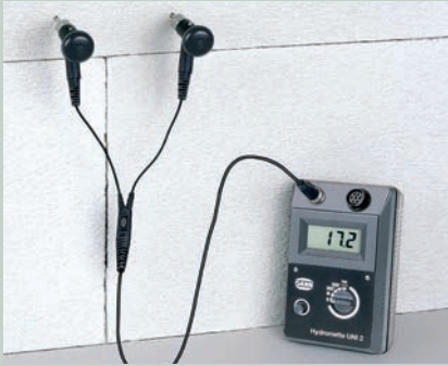
PRAXIS-TIPP Idealer Abstand der Elektroden: 10 cm
