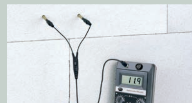
ANWENDUNG Messung mit einem Tiefen-Messelektrodenpaar M 21-250
