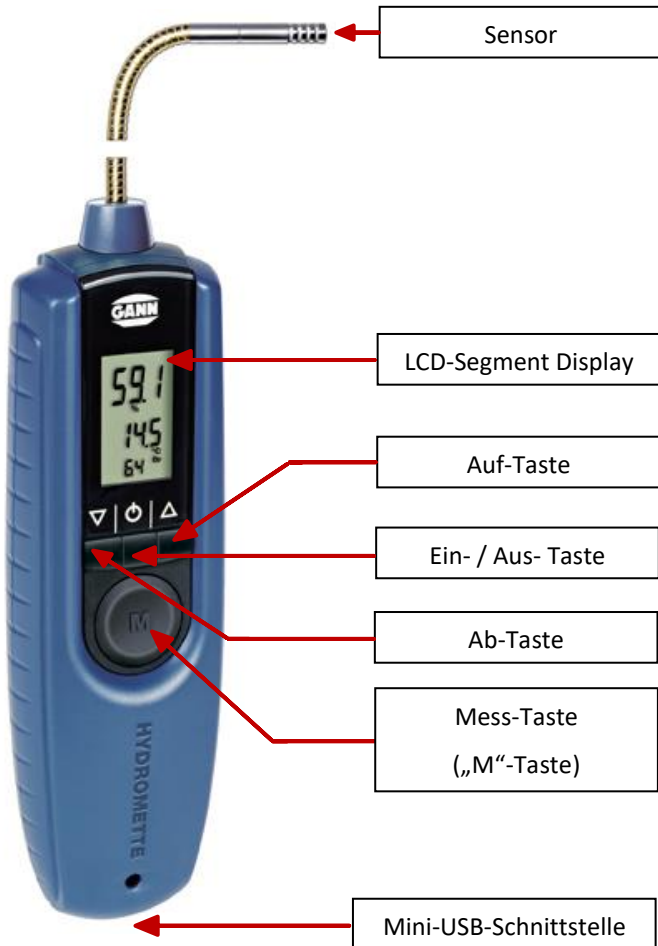
Abbildung 2-1: Ansicht der Hydromette BL Compact RH-T
