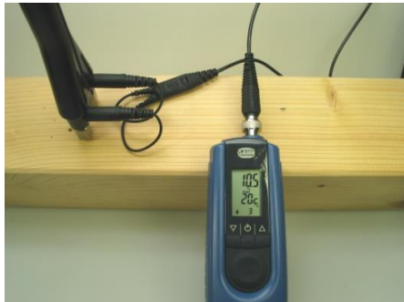
Abbildung 4-3 Messung quer zur Faserrichtung mit M 20
