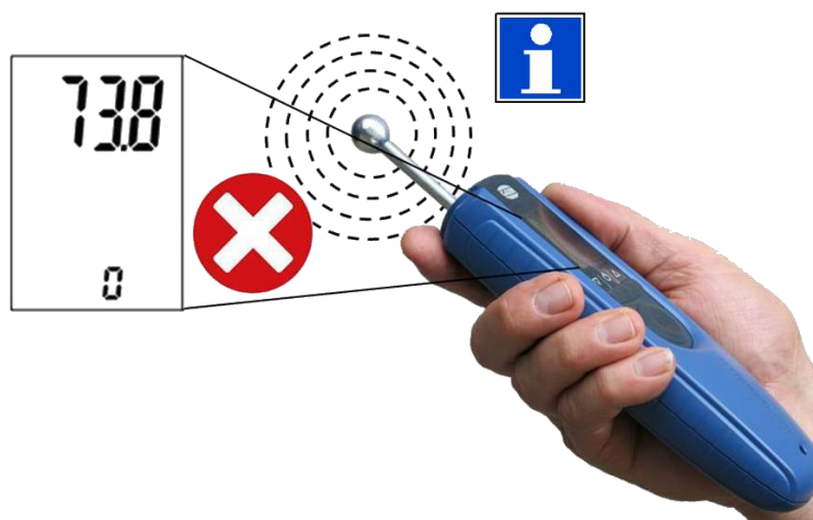
Illustration 9-2 : Mauvaise manière de tenir l'appareil
