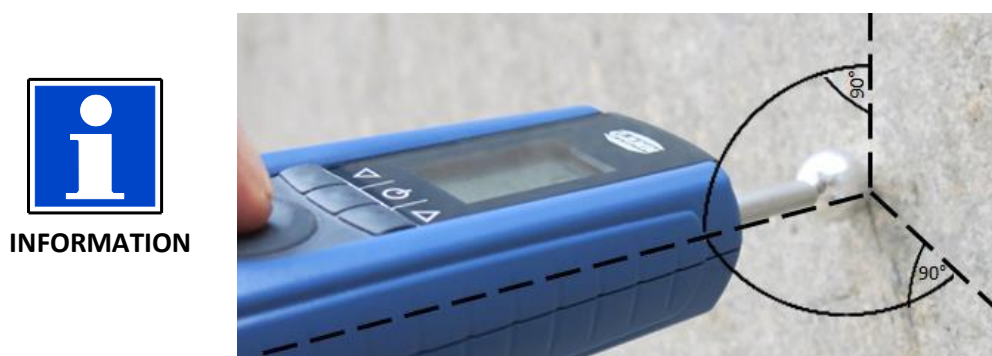
Illustration 9-3 : Mesure à effectuer le plus perpendiculairement possible à la surface de mesure
