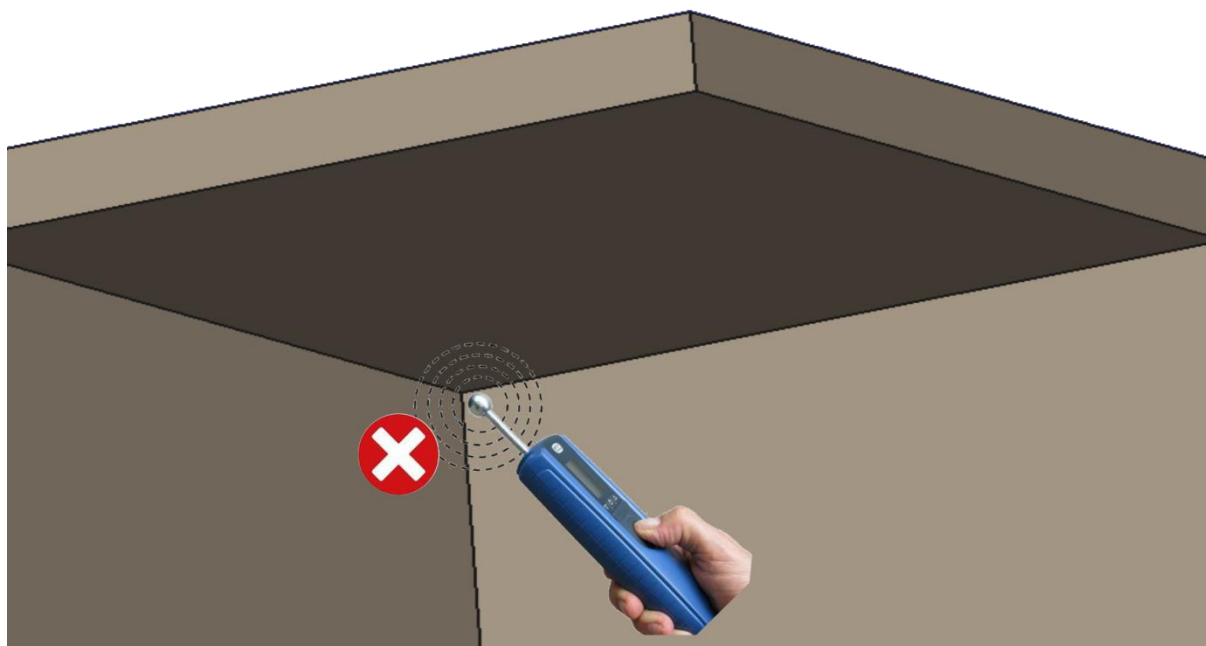
Illustration 9-6 : Mauvaise application dans un coin/angle
