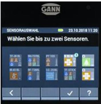
Zur Aktivierung des kapazitiven Mess-Modus muss nun das Symbol „B 55 BL“ ausgewählt werden. Durch Drücken des Buttons „Bestätigen“ wird die Auswahl bestätigt.
