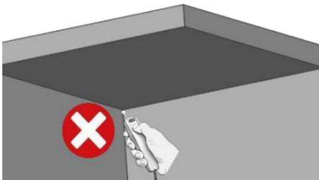
Messungen direkt im Eck-/ Kanten- / Winkelbereich führen zu einer Überlagerung des Messfeldes und verändern dadurch den Messwert!
