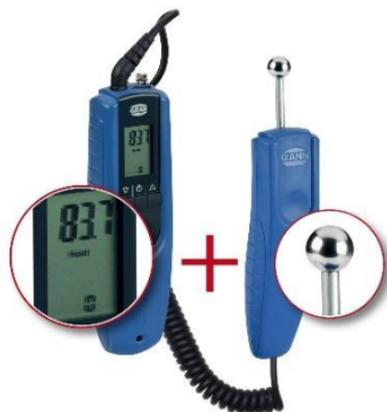
Die Aktiv-Elektrode B 55 BL ist über die 3,5mm-Klinkenbuchse mit dem Messgerät zu verbinden. Dabei ist auf einen festen Sitz des Achtkant-Steckers zu achten. Das Messgerät erkennt nun automatisch das angeschlossene Zubehör. Zur Aktivierung des kapazitiven Messmodus muss nun die „**M**“-Taste **länger** als 2 Sekunden gedrückt werden.
