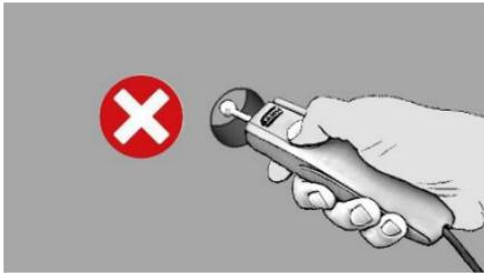
Messungen im Bohrloch führen zu Fehlmessungen. Hier kommt es zu einer Überlagerung des Messfeldes und dadurch zu einer Erhöhung des Messwertes.
