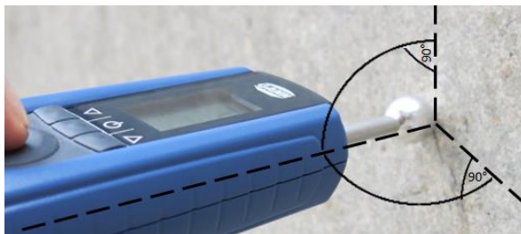
Fig. 4-3 Måling så lodret som muligt ift. målefladen.
