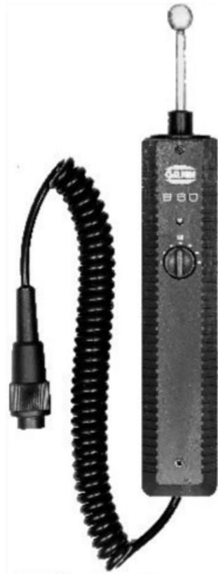
Sonda attiva con elettronica integrata per la localizzazione non distruttiva d'umidità in materiali da edilizia di ogni genere nonché per il riconoscimento della distribuzione d'umidità in pareti, soffitti e pavimenti. L'elettrodo, che funziona con uno speciale metodo di misura, crea un campo di alta frequenza concentrato con alto potere di penetrazione in profondità fino a 120 mm. Con regolatore incorporato del valore di soglia da 20 a 140 digits e relativo segnalatore acustico.
