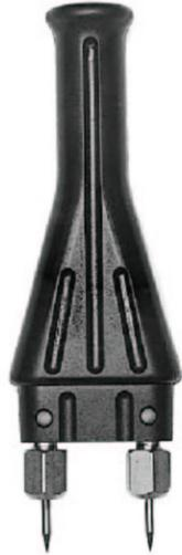
Per misure in superficie ed in profondità di tavolame spesso fino a 50 mm, impiallaccature, pannelli truciolari e pannelli in fibra - nonché per la misura di materiali da edilizia (intonaco, gesso, ecc.) sino ad una profondità di ca. 70 mm
