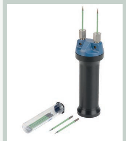
Einstech-Elektrode M 19 mit isolierten Elektroden-Spitzen (60 mm) zur Messung fertig verputzter Wärmedämmverbundsysteme
