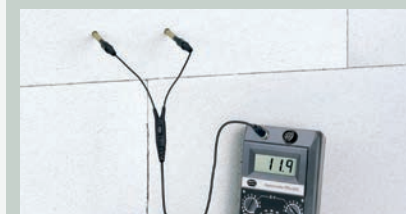
ANWENDUNG Messung mit einem Tiefen-Messelektrodenpaar M 21-250
