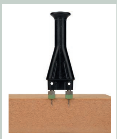
Einschlag-Elektrode M 20 mit speziell iso- lierten Elektroden-Muttern, die den Einfluss von Oberflächenfeuchte verringern
