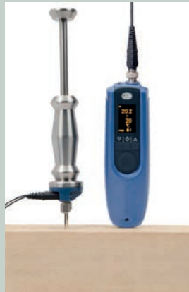
Widerstandsbasierte Feuchtemessung mit einer Ramm-Elektrode M 18 in Hartholz
